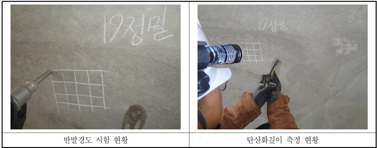
【사진 6.4.1】 콘크리트 내구성조사 현황
